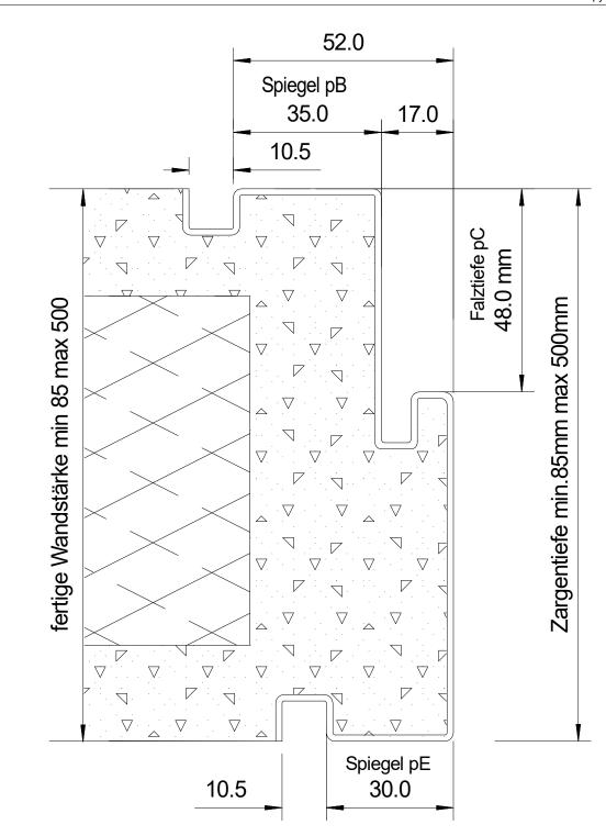
Rohmass= Lichtmass + 60mm je Seite Falztiefe von 25-60mm Spiegel pB von 25-63mm Spiegel pE von 20-80mm
